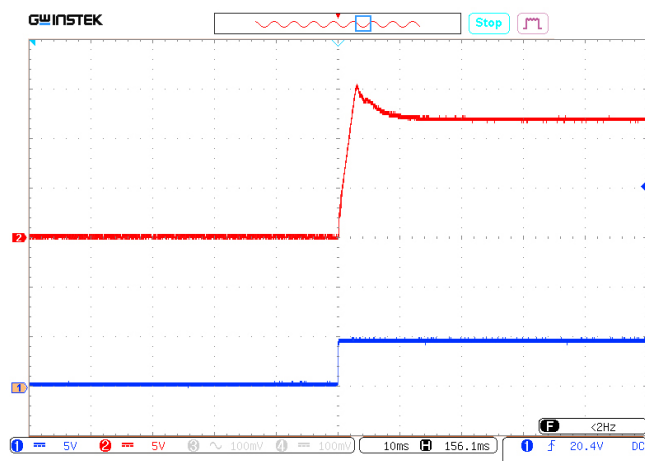
Рис. 21. Осциллограмма установления выходного напряжения с момента подачи команды дистанционного управления.
