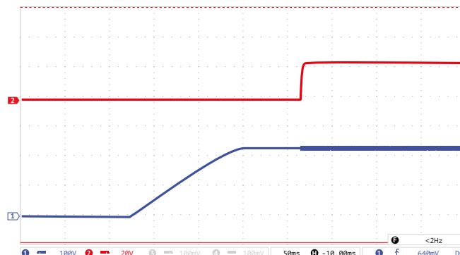
Рис. 18. Осциллограмма установления выходного напряжения с момента подачи входного напряжения.
