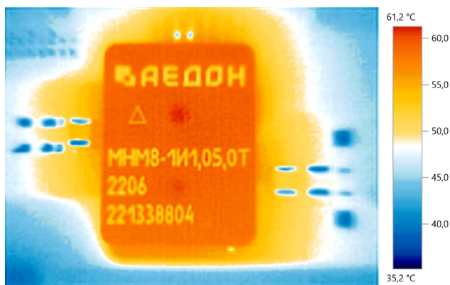
Рис. 31. Верхняя сторона. 61,2 °C
