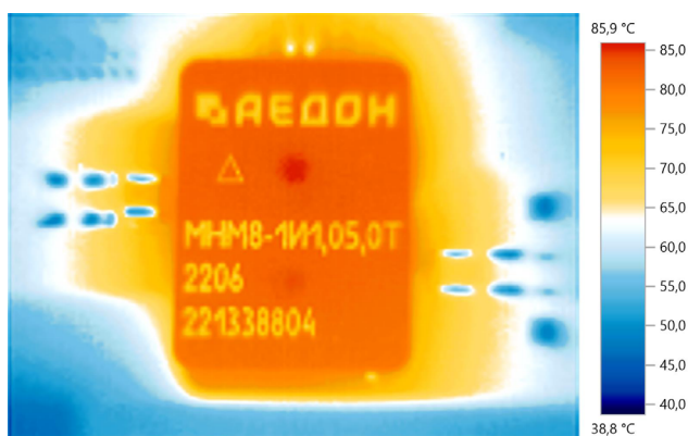
Рис. 33. Верхняя сторона. 85,9 °C
