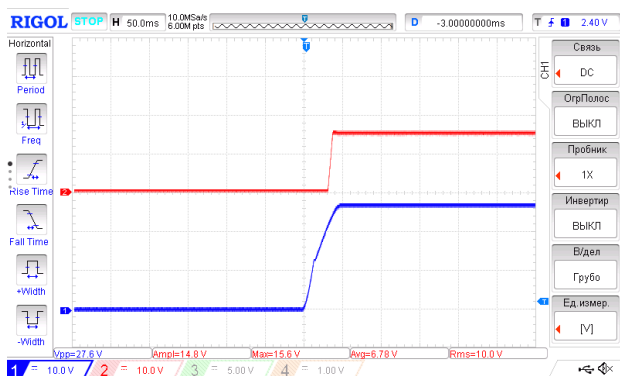
Рис. 20. Установление U_{вых,ном} с момента подачи U_{вх,ном} . Луч 1 (синий) — входное напряжение. Масштаб 10 В/дел. Луч 2 (красный) — выходное напряжение. Масштаб 10 В/дел. Развертка 50 мс/дел.
