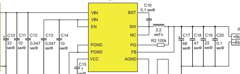
Пример схемы использования неизолированного понижающего преобразователя LMR33630-Q1 совместно с помехоподавляющим фильтром
