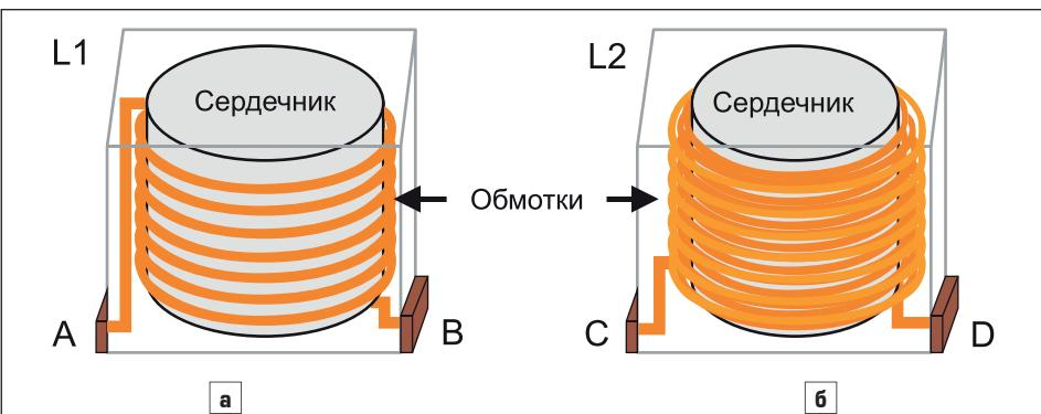
Рис. 2. Упрощенная конструкция однослойного (а) и многослойного (б) дросселей
