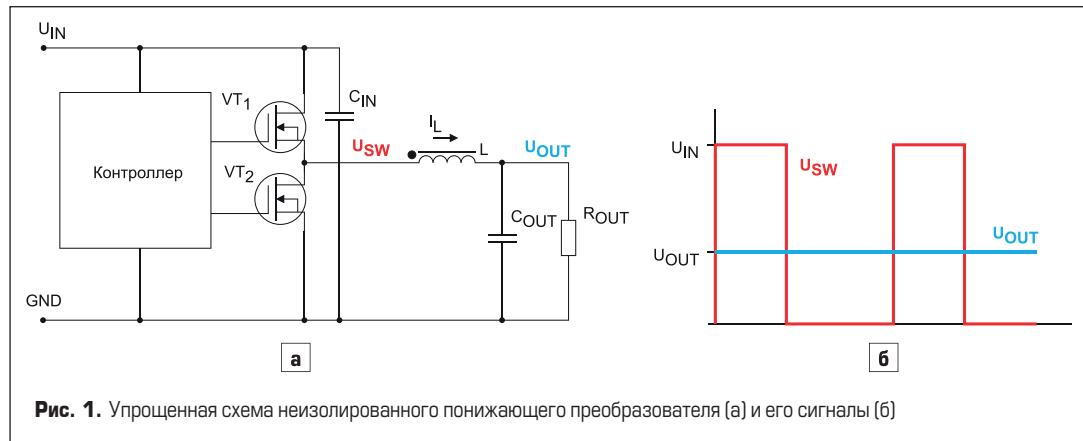
Рис. 1. Упрощенная схема неизолированного понижающего преобразователя (а) и его сигналов (б)
